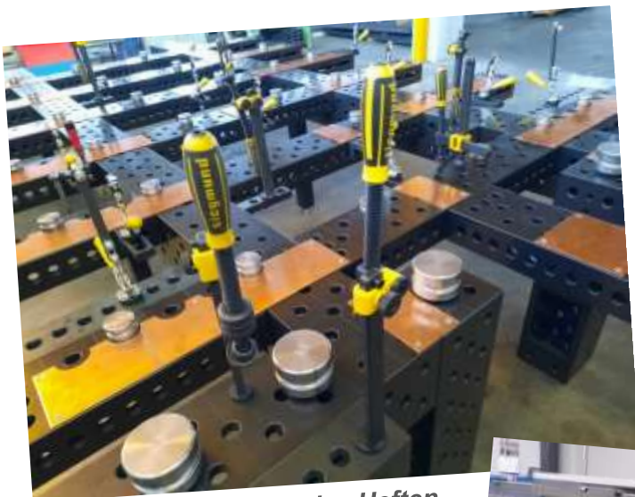
Lehrentisch für das Heften der Containerunterbauten
