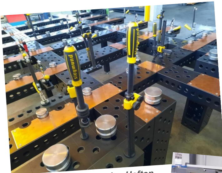
Lehrentisch für das Heften der Containerunterbauten
