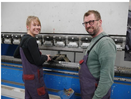
Abkanten eines Rahmenteils
