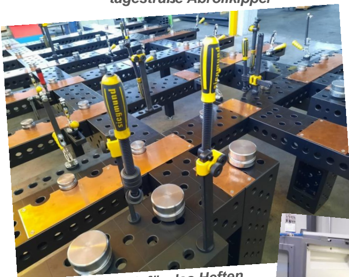
Lehrentisch für das Heften der Containerunterbauten
