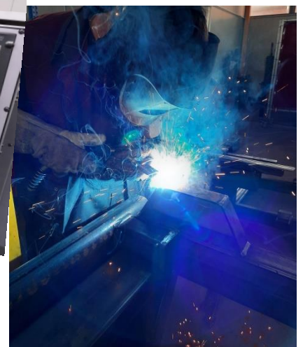
Abschweißen eines Containers
