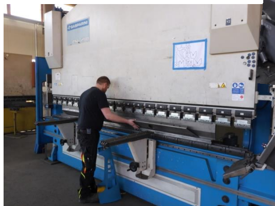
Abkanten eines Rahmenteils
